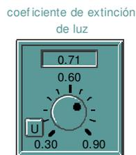
**Reloj:** Permite cambiar el valor del parámetro haciendo girar la perilla. Una U aparecerá en el ángulo inferior izquierdo indicando que se ha realizado un cambio con respecto al valor por defecto.
