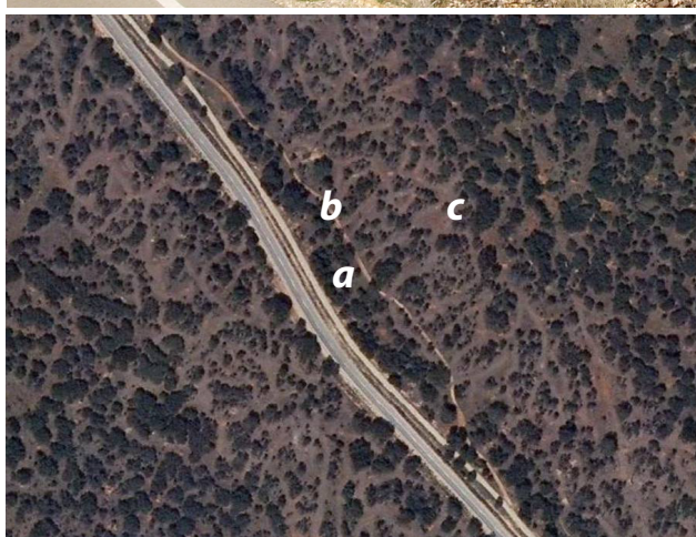
Foto 37. Tratamientos perimetrales de prevención de incendios. Área cortafuegos paralelo a carretera en el cuartel A. De izquierda a derecha se aprecia: a) Faja auxiliar de pista de 10 m (se han aplicado tratamientos de poda, resalveo de conversión y desbroce), b) Faja de ocultación visual de 10 m (sin intervención), d) Resalveo de conversión (80m).
